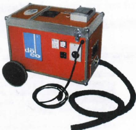
Le surpresseur **DÖLCO** insuffle de l'air sec et chaud dans la couche isolante ou dans les espaces creux à assécher.
